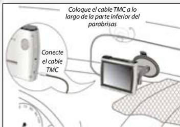
Instalación del cable de la antena TMC para recibir información sobre el tráfico.
